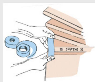
Les étiquettes en papier doivent être collées au dos du livre avant de le couvrir puis recouvertes avec du film de protection pour cotes prédécoupé ou non lorsque les livres sont couverts. Pour cela, le film doit dépasser de l'étiquette d'environ 1 cm en haut et en bas et aller jusqu'au plat de la couverture du livre à gauche et à droite, afin de conserver assez de marge pour la fixation.
