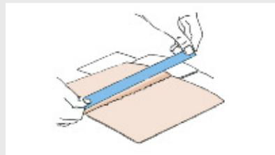
Pour recoller une page détachée d'un livre, prenez un morceau de ruban adhésif dans le distributeur d'une longueur légèrement supérieure à celle du livre. Pliez ensuite le ruban en deux dans le sens de la longueur et placez d'abord la moitié de celui-ci sur la page détachée puis l'autre moitié sur la page opposée dans le livre. Collez le ruban adhésif en l'appliquant bien à l'aide d'un plioir pour obtenir une fixation parfaite. Terminez en coupant le ruban qui dépasse à l'aide de ciseaux.
